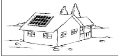
يمكن وضع الألواح الشمسية على أسطح المنازل لجمع الطاقة من الشمس واستخدامها لتسخين المياه أو توليد الكهرباء. لوحات الكبيرة تنتج المزيد من الحرارة الشمسية وإنتاج المزيد من الطاقة.
