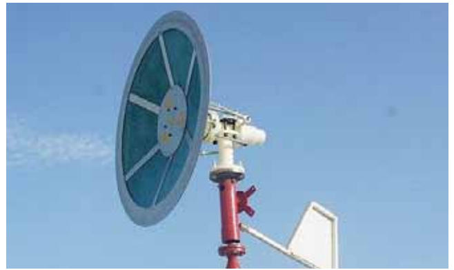
新型 Saphonian 风力发电机不用叶片。 照片提供：Saphon Energy
